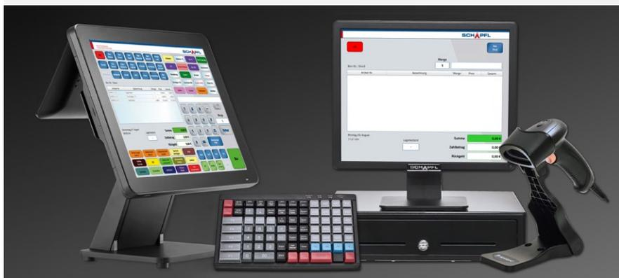
Eine Kasse besteht aus vielen verschiedenen Einzelkomponenten: Kassenschublade, Monitor, Tastatur, Waage, Scanner, Bondrucker, EC-Gerät, usw. Alle Komponenten werden über die Funktionen im Kassensystem angesteuert und koordiniert: Wann geht die Kassenschublade auf? Wird die EC-Kartenzahlung richtig erfasst? Können an der Kasse Artikel über die Waage abgerechnet werden? Arbeitet der Scanner einwandfrei? Und, und, und.
